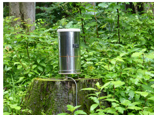
工事現場に設置された雨量計
