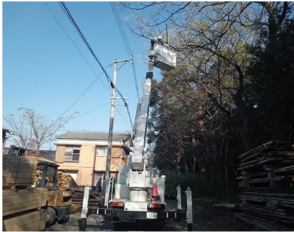
危険木処理の様子（高所作業車使用）
